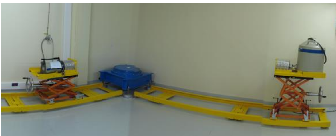
Figure 1 : Principaux composants du système actuel de spectrométrie gamma au labo C2 - CHICADE
