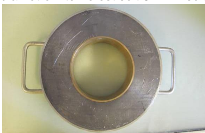
Figure 18 : Rondelle de \varnothing_{\text{intérieur}} 109mm
