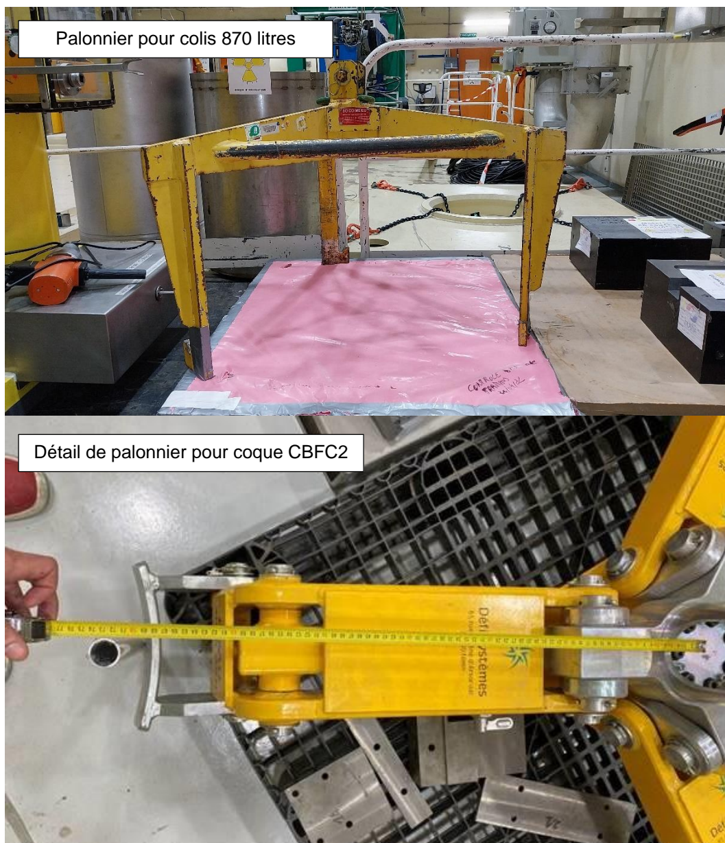
Figure 12 : Photographies de palonniers de manutention pour les colis 870 litres et CBFC2
